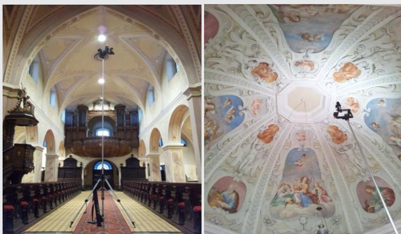
Obr. 15. Ukážka "robotického snímkovania zo statívu" pomocou statívu NEDO Industrial Line.
