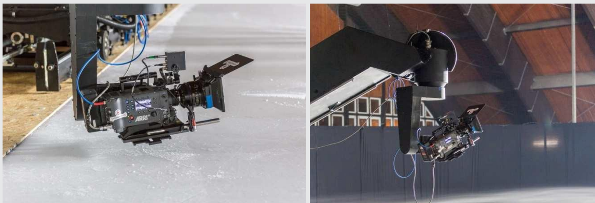
Obr. 35. Kamera Arri Alexa Xtended Technology umiestnená na kamerovom rigu MILO motion control.
