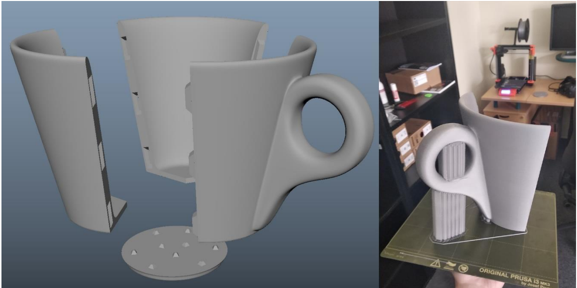
26 - Model komponentov šálky na 3d tlač a fotografia vytlačeného komponentu
